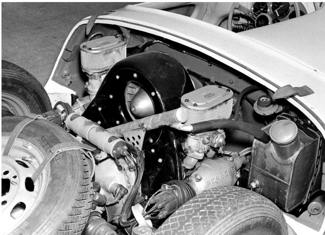
Abbildung 7: Eingebauter Fuhrmannmotos (Typ 547) in einem Spyder 550
